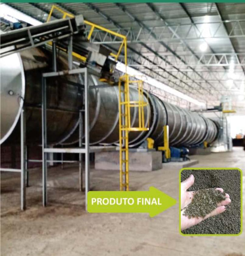
O DESIDRATADOR CONTÍNUO DESENVOLVIDO E PATENTEADO PELA TECNOBACH, POSSUI UMA TECNOLOGIA NA QUAL EVAPORA-SE O EXCESSO DE UMIDADE DO MATERIAL, BAIXANDO DE ~ 75% PARA ~ 20% DE UMIDADE. AINDA NESTE PROCESSO, O MATERIAL SOFRE TRATAMENTO TÉRMICO QUE ELIMINA BACTÉRIAS E DOENÇAS, ALÉM DE ESTABILIZAR O MATERIAL, ELIMINAR O MAU CHEIRO E POR FIM, GRANULAR. CAPACIDADE: 50 MIL A 1 MILHÃO AVES/DIA. PROCESSOS CUSTOMIZADOS.
